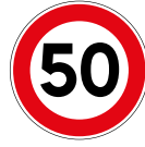
BK 14* Limitation de vitesse. Ce panneau notifie l'interdiction de dépasser la vitesse indiquée
