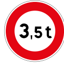
BK13* Accès interdit aux véhicules dont le PTAC ou le PTRR excède le nombre indiqué
